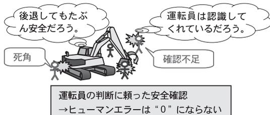
図—2 建設機械操作における安全確認時のヒューマンエラー
