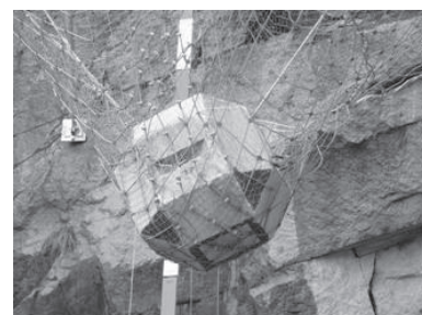
写真－3 (3) 試験4重錘捕捉状況
