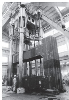
大型疲労試験機
