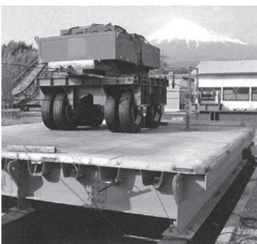
屋外輪荷重疲労試験装置
