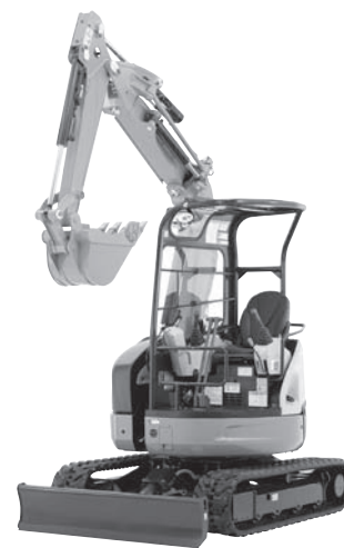
写真一 3 クボタ「TOUGH」RX-306 ミニショベル
