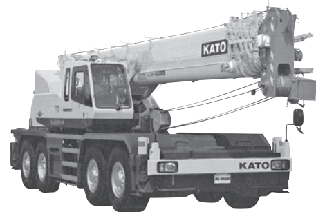
写真-6 加藤製作所 SL-600R PREMIUM ラフテレーンクレーン
