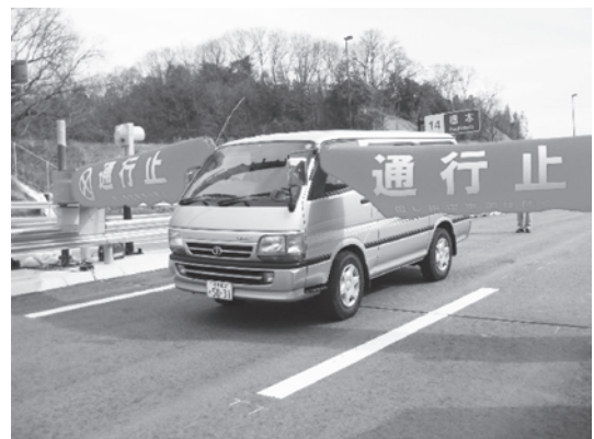
写真-6 バルーン式自動交通遮断機
