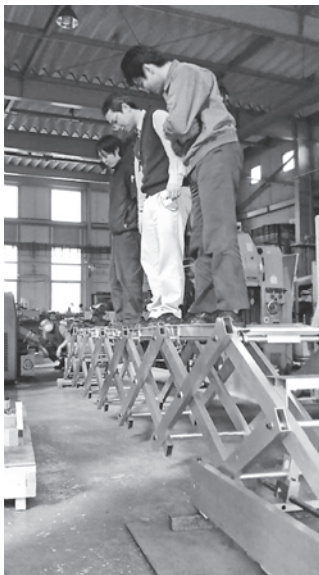
写真-5 載荷試験状況 (大人3名で載荷)
