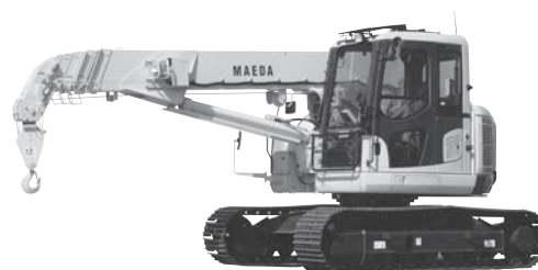
写真-4 前田製作所 LC1385M-8 クローラクレーン
