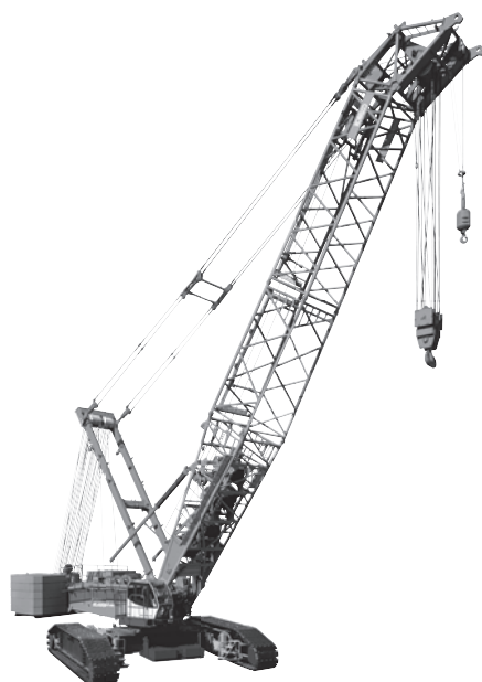
写真-3 コベルコクレーン SL4500J-350 クローラクレーン
