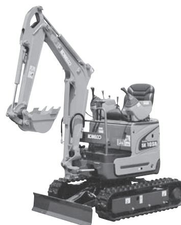
写真-1 コベルコ建機 SK008 (上) と「ビートル」SK10SR (下)
