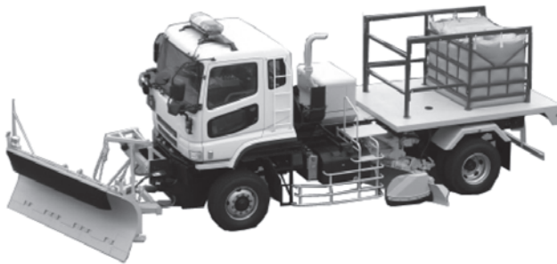
写真—7 散水装置を積載した除雪トラック
