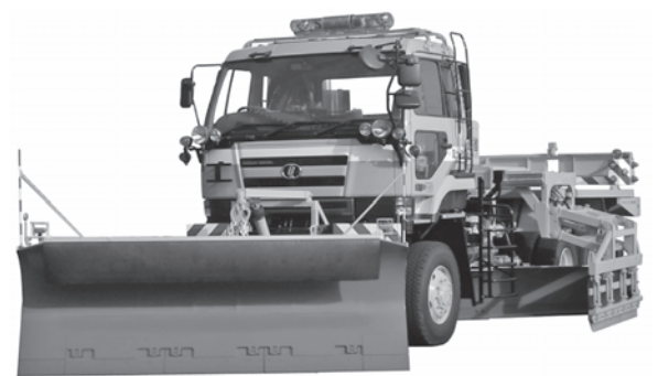
写真一 6 除雪トラックの外観
