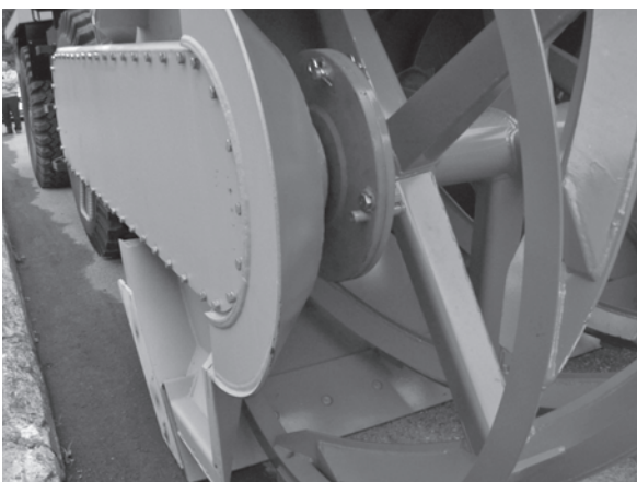
写真一 4 動力伝達部のシャーピン
