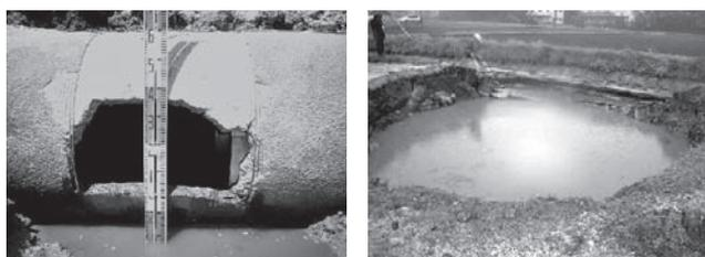
写真—1 PC 管破裂と地表面陥没事例
