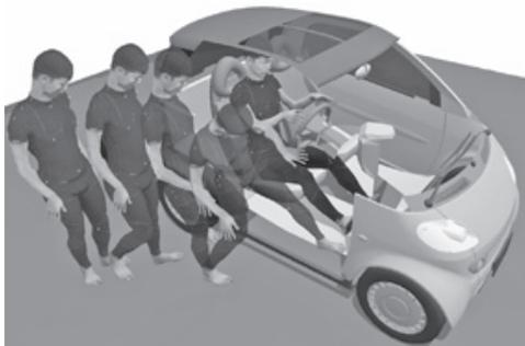
図一3 設計寸法に応じて生成された乗車動作
