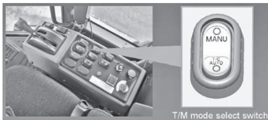
図一3 T/M モード切替スイッチ
