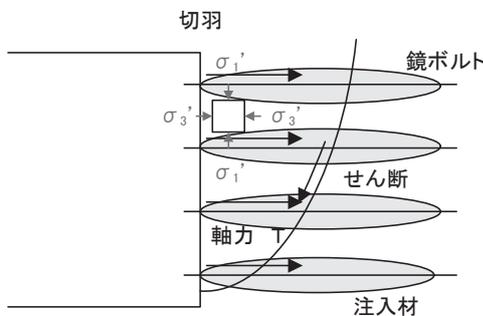
図二 鏡ボルト工の作用効果
