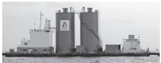
写真三 固化材供給船「SEAGULL」
