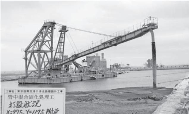
写真—4 ポンプ式専用打設船「関翔」
