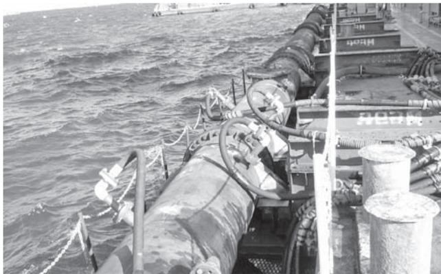
写真一六 実際の圧送管に設置されたパイプシャワー
