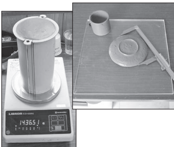
写真一五 密度試験，フロー試験状況
