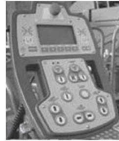
写真9-14 フェーゲル(独) ERGO PLUS スクリード部パネル
