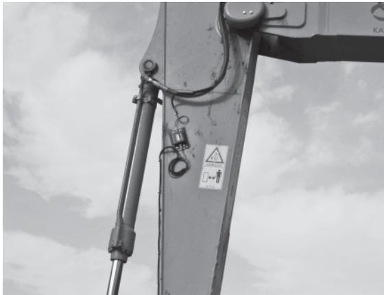
図-3 可動部の角度センサー
