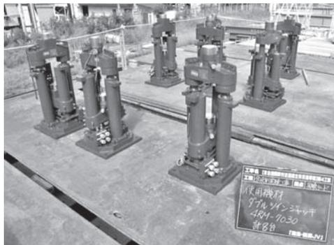
写真—3 ダブルツインジャッキ概要
