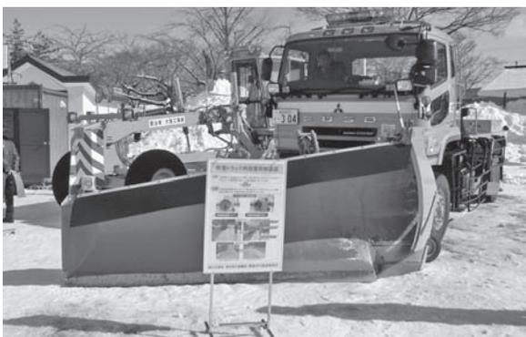
写真-5 投雪抑制装置付除雪トラック
