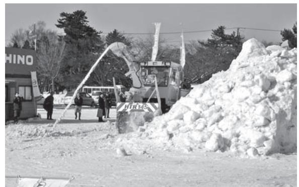
写真-8 ロータリ除雪車 1.5m 級
