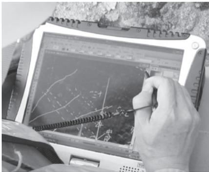
写真—1 岩盤スケッチ実施状況
