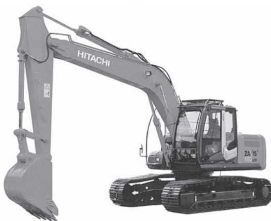
写真一 1 日立建機 ZX180LCN-3 油圧ショベル (解体仕様)
