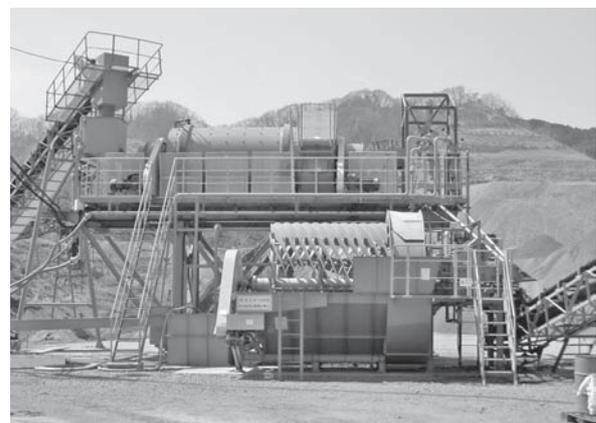
写真一 ガリバー砂製造装置
