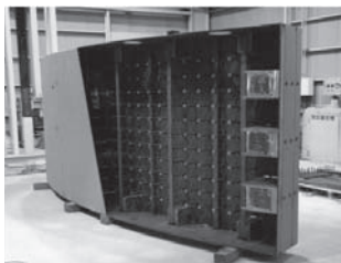
鋼殻の完成状況（背面 PL 撤去）
