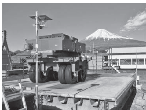
写真一八 屋外輪荷重疲労試験機 <1号機>
