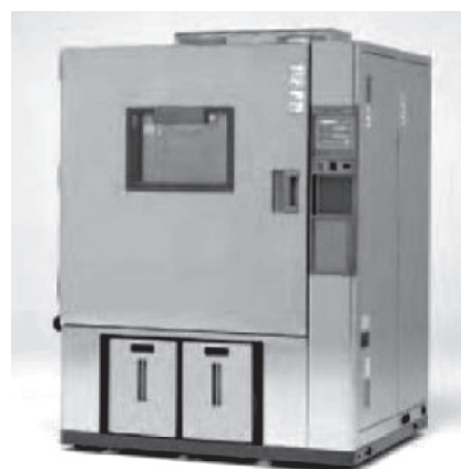
写真—4 恒温恒湿槽
