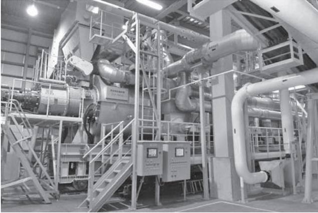
写真—2 間接熱脱着装置
