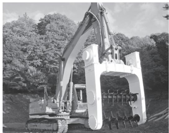
写真一1 DAM工法機の攪拌混合部
