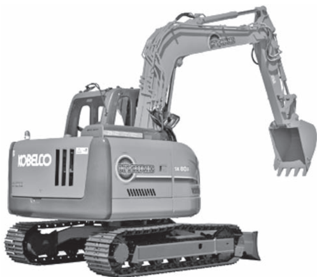
写真一2 コベルコ建機 SK80H-2 油圧ショベル (ハイブリッド形)
