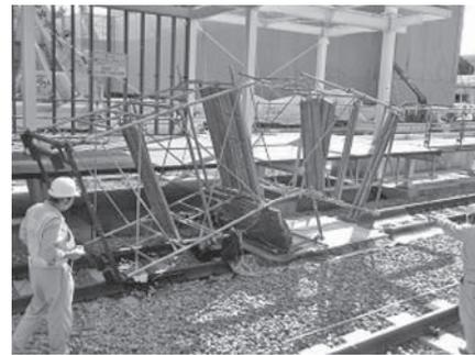
写真—12 トロ台車転倒実証実験
