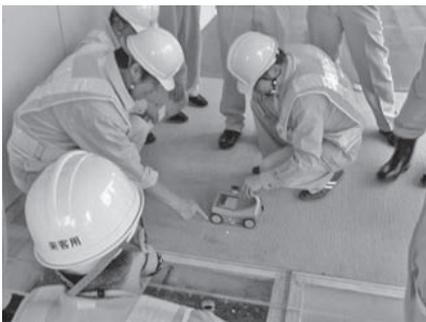
写真—11 埋設物探査
