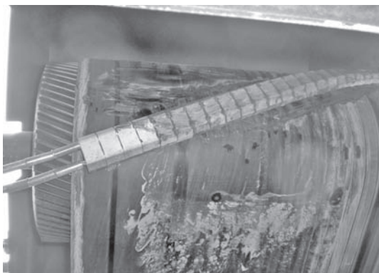
写真一五 セラミック製クリーナー装着例
