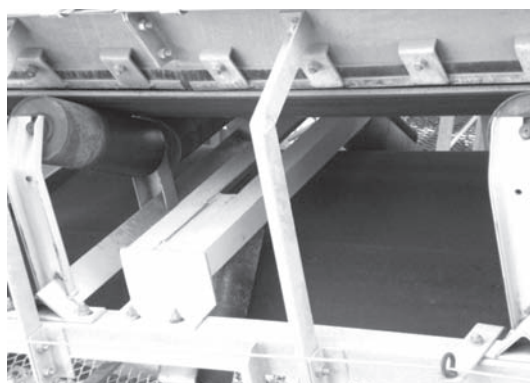
写真一八 A型リターン押さえ
