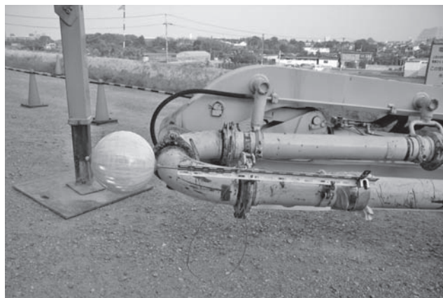
写真一5 ポンプ車への球面リフレクタ取付け例 ※ブームが屈折する機種には2箇所以上取付
