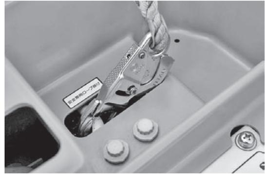
図一五 安全帯インターロック（安全帯を取付ける事で操作が可能になる）
