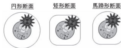
図-4 アポロカッター工法適用例
