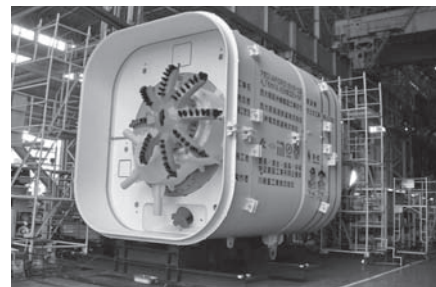
写真-1 4.76m(縦)×4.42m(横) 地下通路対応シールド掘進機
