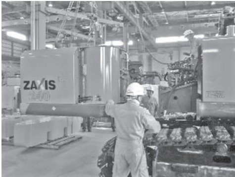
写真一11 下部フレーム接合状況
