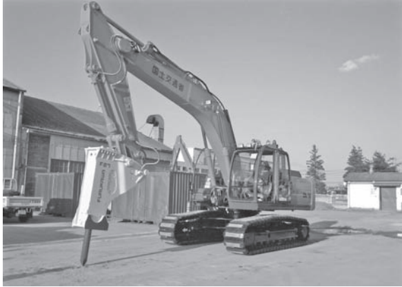
写真—6 油圧ブレーカ
