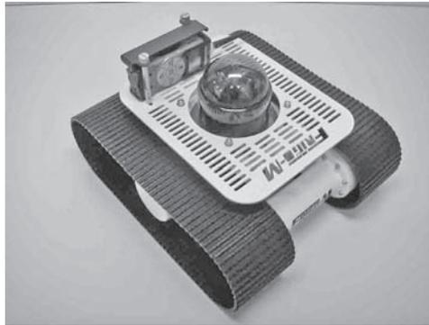
図-5 検知器を搭載したプロトタイプ
