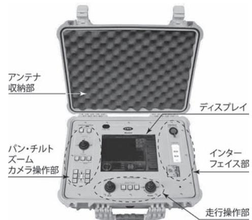
図一八 量産製品型操縦装置
