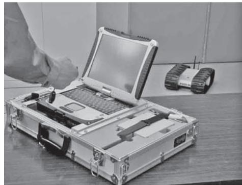
図一 4 プロトタイプ操縦装置
