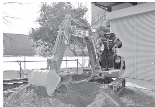
図-3 人間型ロボットによる代行運転
