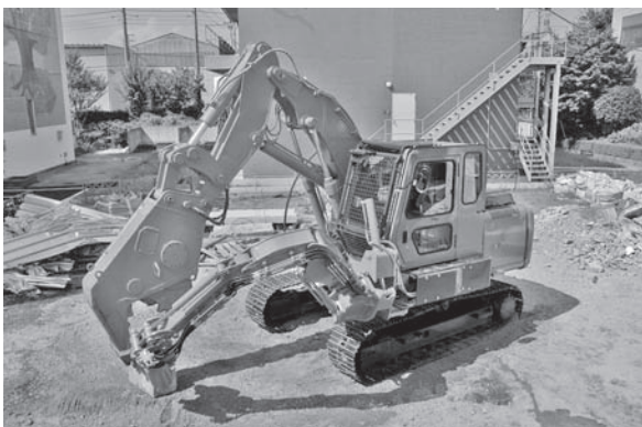
図—4 双腕型建設用マニピュレータ
