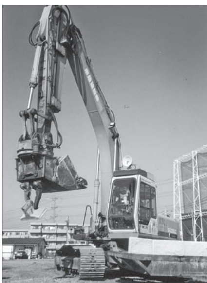
図-1 土工機械の遠隔操作システム
