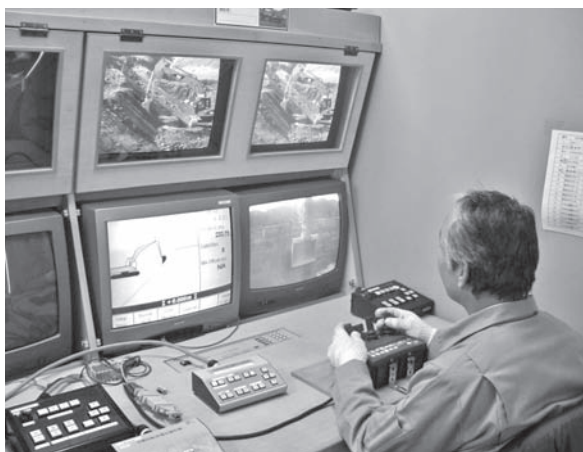
写真—1 無人化施工と情報化施工の融合
