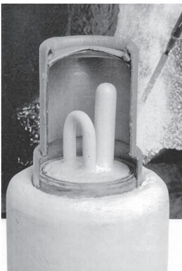
写真-1 測温プローブ先端の熱電対
