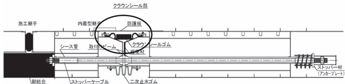
図一 10 クラウンシール継手の構造
