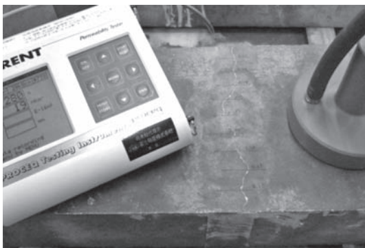
写真一六 表面透気試験状況
