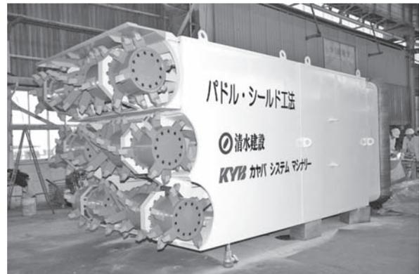
写真一2 上段カッタ格納時全景
