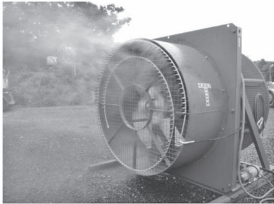
冷却能力 180 kW 風量 2,100 m 3 /min
