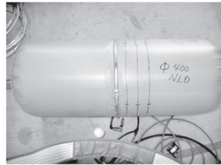
φ 400 ノンリークダクト リーク試験風景 20 kPa (110 m 3 /min 相当) リーク量 0.5ℓ/min (漏風率 β = 0.00005)
