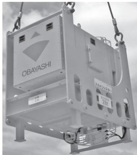
回転制御能力：1225kN・m<sup>2</sup> (WL<sup>2</sup>/12)
