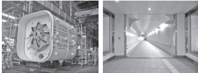
写真—7 アポロカッター工法が適用された地下通路
