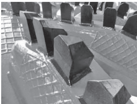
写真-4 片刃のカッター配置状況
