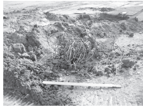
写真一7 水洗浄後の攪拌翼に巻き付き破断した PC 鋼線
