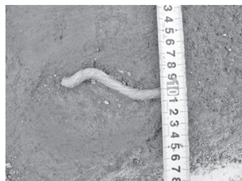
写真一9 混合攪拌にて破断された PC 鋼線の小片
