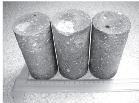
写真一5 コア供試体状況
