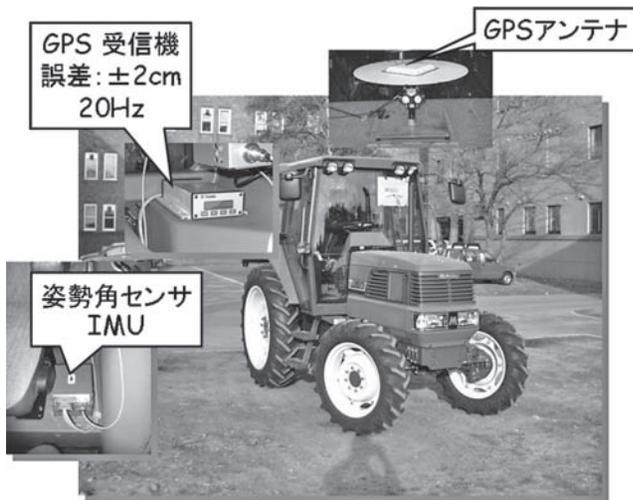
写真-1 車輪ロボットトラクタと航法センサ
