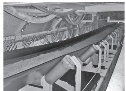
写真—2 ベルトコンベアによる土砂搬出状況
