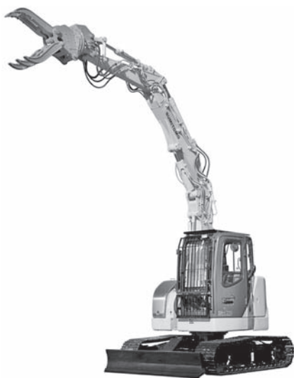
写真一 3 住友建機 SH75X-3BKK 油圧ショベル (木造家屋解体仕様)
