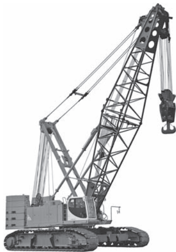
写真一 5 日立住友重機械建機クレーン SCX2000A-2 クローラクレーン
