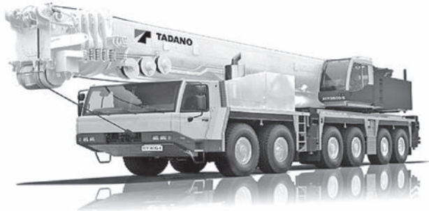
写真一七 タダノ ATF360G-6 オールテレーンクレーン
