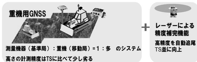
図-9 TK-GNSS方式の特徴
