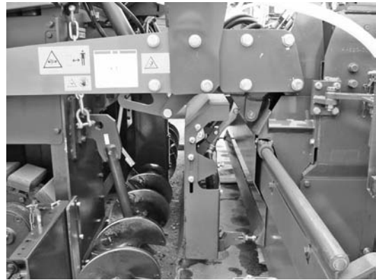
写真一七 追加モールドボードと散水装置
