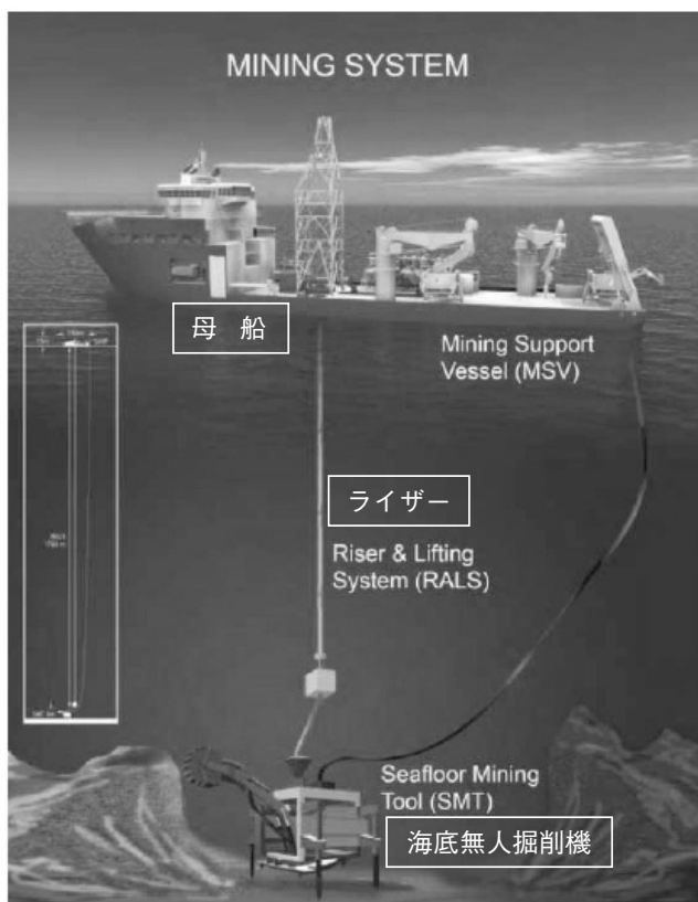
図-7 Technip社が提案する海底熱水鉱床の生産概念図：海底に掘削機を降ろし、掘り砕いた鉱石を海上の母船まで吸い上げる。日本でも同様の方法と考えられる。
