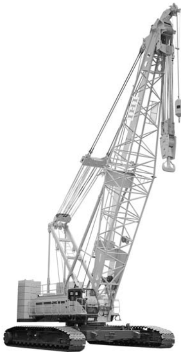
写真一 3 IHI 建機 CCH2000-6 クローラクレーン
