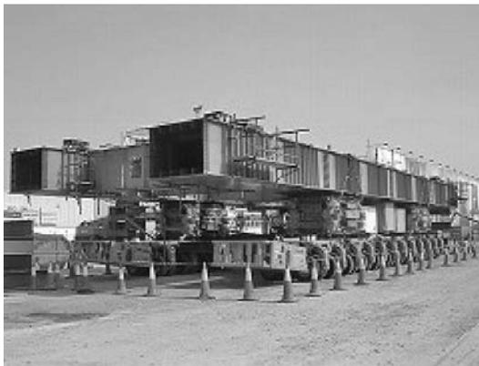
写真-4 SPMT (SJと工事桁を積載した状態)
